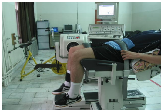
شکل ۲: نحوه اندازه‌گیری گشتاور اکستانسوری مفصل زانو
